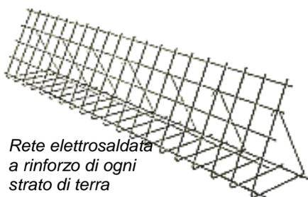
Rete elettrosaldata a rinforzo di ogni strato di terra
